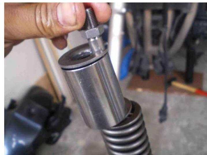
Rimontiamo in sequenza inversa tutti i particolari rimossi: rondella, distanziale, piattino. Quest'ultimo eviterà che l'asta del pompante scenda all'interno della forcella.
