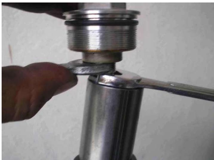
Ora dobbiamo togliere il tappo della forcella. Per farlo dobbiamo allentare il controdado. La parte inferiore della vite del precarico (1) è fresata. Inseriamoci una delle chiavi da 14. (Nel caso non ci sia spazio sufficiente, basta avvitare la vite). Svitiamo il controdado e libereremo il tappo.
