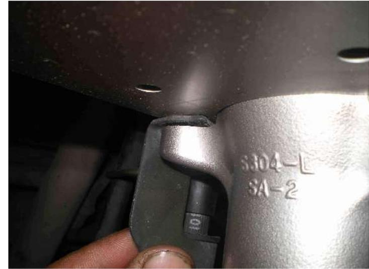
Terminate tutte le fasi precedenti andiamo a rimontare il parafango, facendo attenzione a posizionare correttamente le guide cavo dei tubi freno
