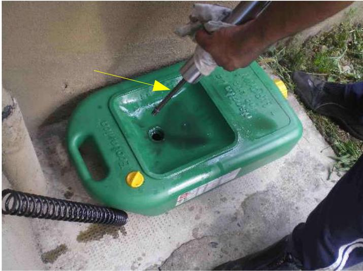
Ogni tanto muovete in su ed in giù anche l'asta del pompante per favorire lo svuotamento.... ripetete l'operazione più volte fino a che non scende più olio.
