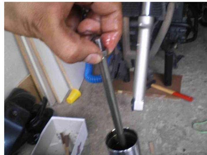
Raggiunto il livello previsto, rimontiamo la forcella: cominciamo con il sollevare l'asta pompante. Conviene farlo adesso in quant farlo a molla inserite è molto difficoltoso.
