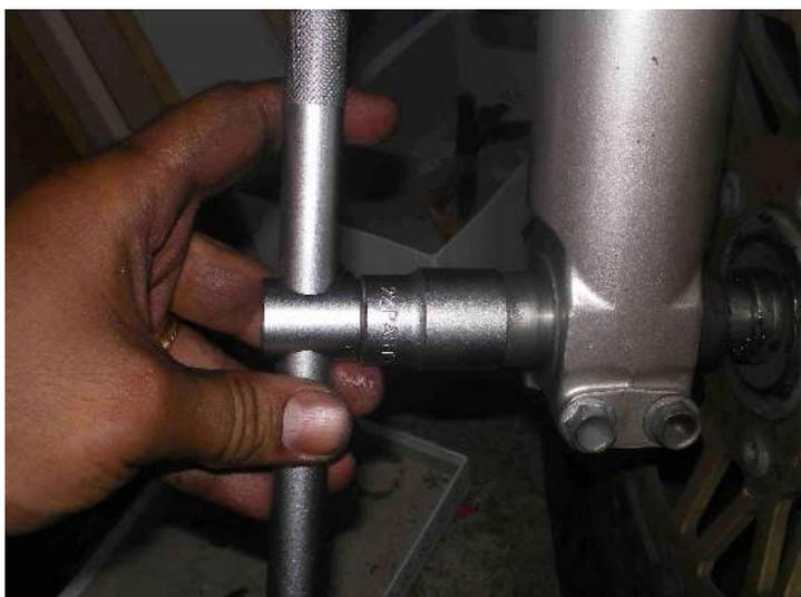
Andiamo a fissare definitivamente il perno ruota (Coppia: XX Nm) e le relative viti (Coppia: XX Nm)
