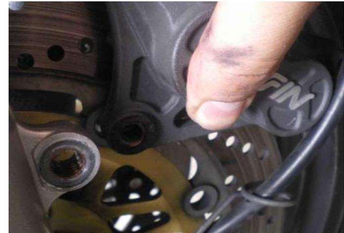
Per essere certi di reinserire senza problemi la pinza successivamente, prima di sfilarla completamente dal disco, muovetela di lato facendo perno sul disco per allargare i pistoncini..
