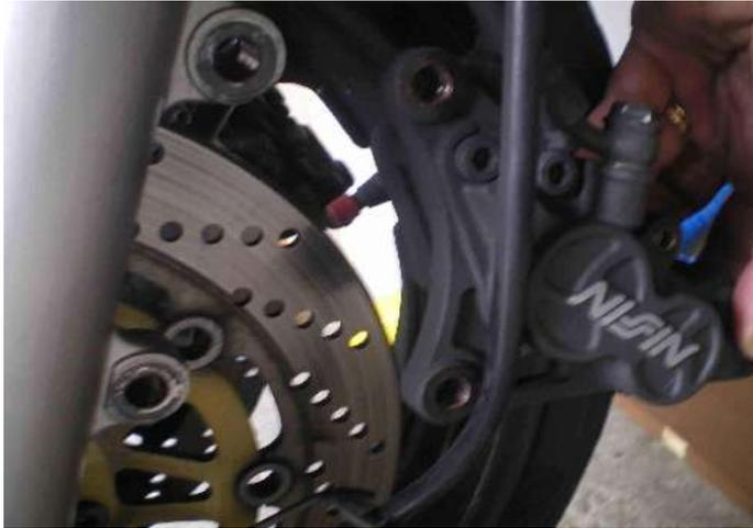
Rimuoviamo la pinza facendo attenzione a non strisciare il cerchio. Per evitare danni potete mettere del nastro da carrozzieri e rimuoverlo una volta finito il lavoro.
