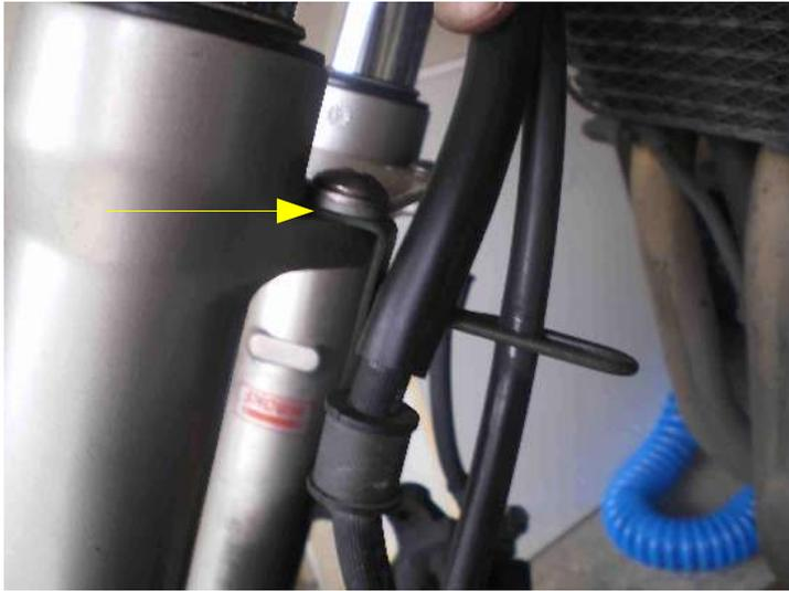
Le viti posteriori della piastra tengono anche le guide dei tubi freno. Rimuoviamole entrambe.....
