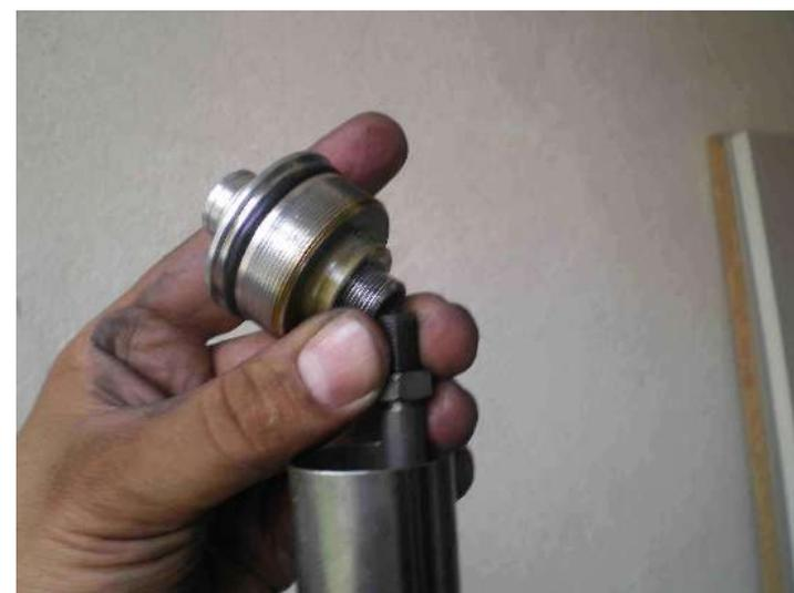
Il tappo della forcella a sua volta è avvitato sull'asta del pompante, per rimuoverlo basterà svitarlo....
