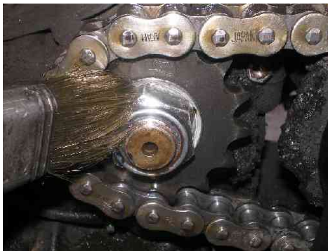
Per agevolare lo sblocco ho pulito la zona con del petrolio bianco e poi ho spruzzato dello Svitol. Poi con il martello in plastica ho picchiettato sul pignone e sul dado.
