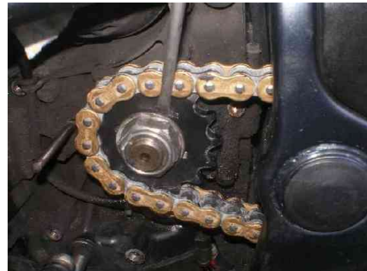
Pieghiamo la rondella di sicurezza e rimontiamo il carter copri pignone
