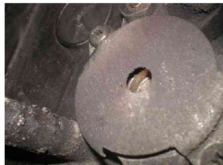
...prima parlavo della sede del pistoncino dell'attuatore posto all'interno del carter pignone... eccola....
