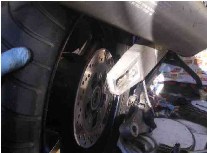
Ora inclinando di lato la ruota toglietela e mettetela da parte. La prenderemo in seguito per sostituire la corona
