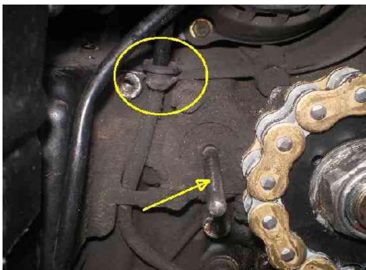
Rimontando il carter fate in modo che la sede del pistoncino dell'attuatore vada ad inserirsi sul perno dell'attuatore (indicato dalla freccia). Mettendolo in posizione controllate che il bloccafilo (nel cerchio) sia posizionato correttamente.
