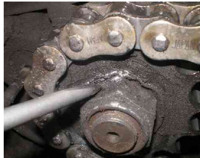
Abbassiamo l'aletta della rondella di sicurezza posta sotto il dado. Nel farlo io l'ho rovinata...poco male...
