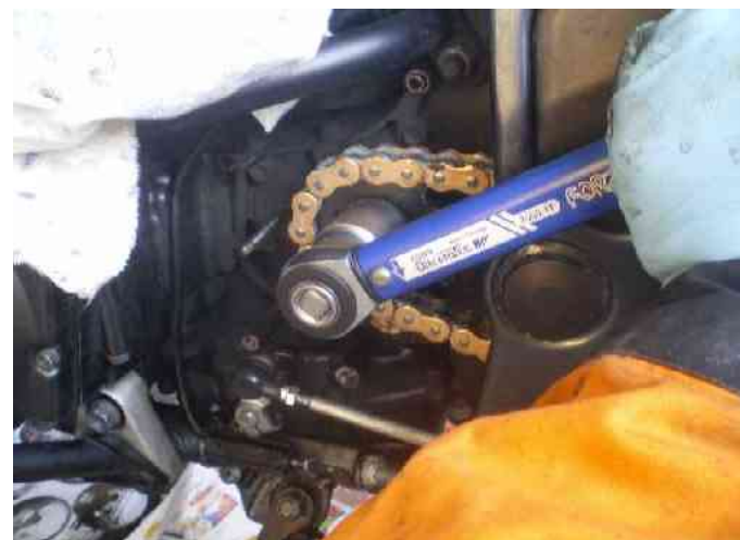
Dopo aver opportunamente bloccato la ruota inserendo un tubo tra il forcellone e la razza del cerchio, usando una chiave con un lungo braccio ho fatto forza ed ho allentato il pignone.
