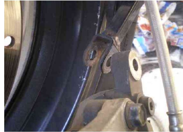
Per poter liberare agevolmente la ruota posteriore, sfilate la pinza dall'asta che la vincola al telaio
