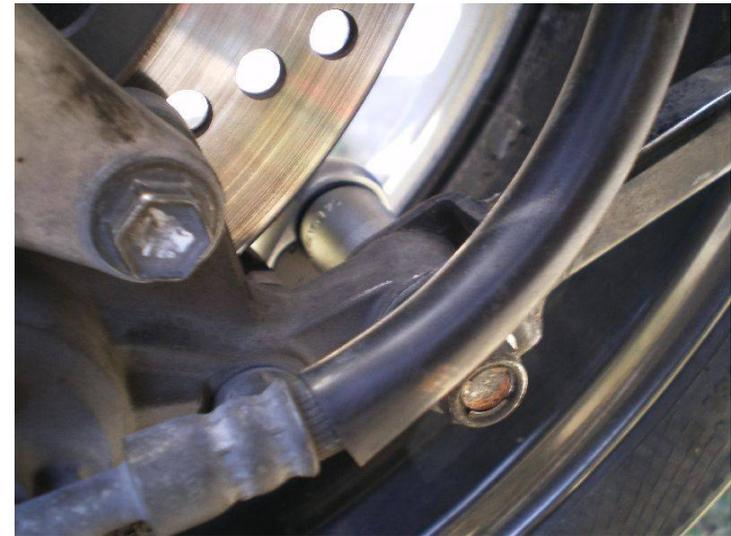
...per il serraggio del terzo punto di ancoraggio, posizioniamo il cricchetto sulla parte posteriore del bullone...
