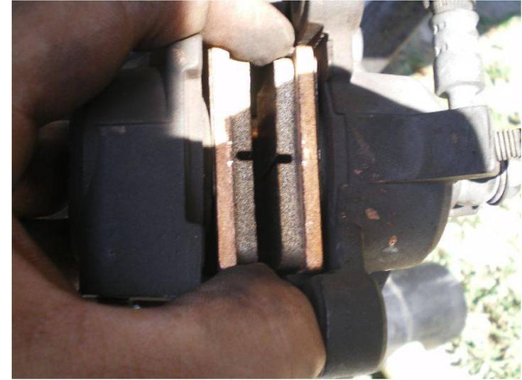
...verifichiamo la posizione delle pastiglie allargandole il più possibile per favorire il passaggio del disco al momento del posizionamento della pinza.
