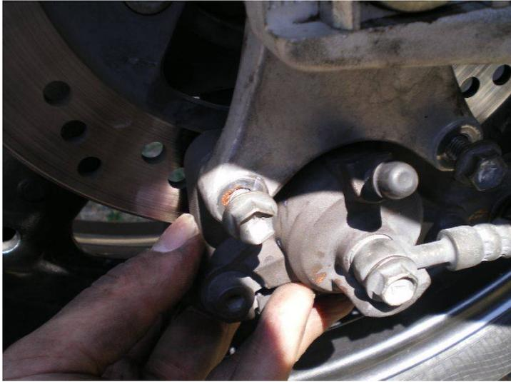
Avvitiamo i bulloni di bloccaggio della pinza
