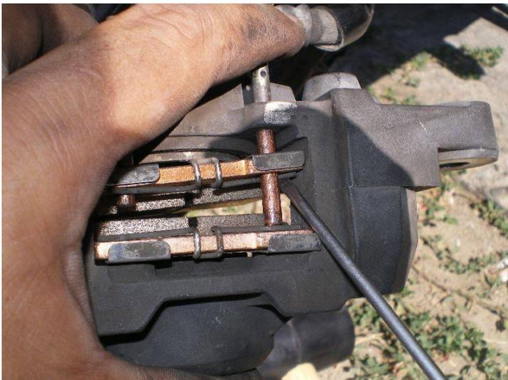
...per agevolare l'inserimento del perno bisognerà abbassare le molle con l'aiuto di un cacciavite...
