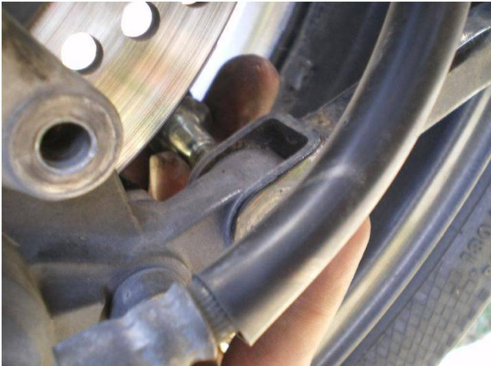
Mettere in posizione la pinza, inserendo per prima cosa il bullone della staffa di fissaggio...
