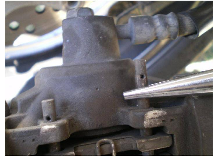
...facendo molta attenzione afferriamo con la pinza a becchi i perni e spingiamoli verso l'alto muovendoli leggermente a Dx e Sx...una volta usciti sulla parte superiore afferriamoli e sfiliamoli del tutto
