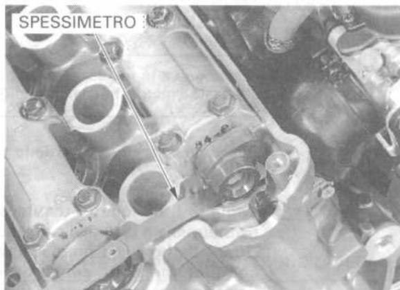
Girare l'albero motore in senso orario di mezzo giro (180°), allineare la tacca di indice sul rotore del generatore di impulsi di accensione in modo che essa sia rivolta verso l'alto, come indicato.
