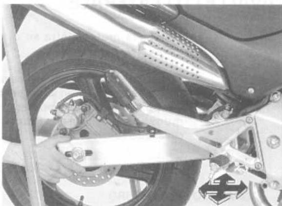
Controllare l'azione dell'ammortizzatore comprimendolo più volte.
