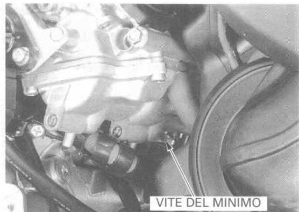
Controllare che la differenza della depressione fra i carburatori non differiscano di più di 30mm Hg dal valore del carburatore base.
