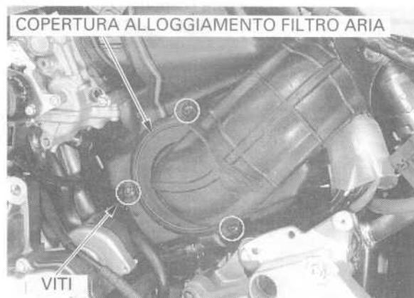
Estrarre e gettare l'elemento del filtro aria secondo il programma di manutenzione (pag. 3-3).
