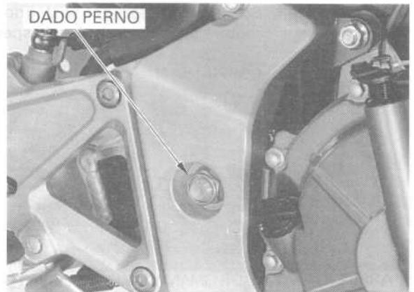
Installare il bullone/dado del sostegno anteriore sinistro motore e il colletto distanziatore.
