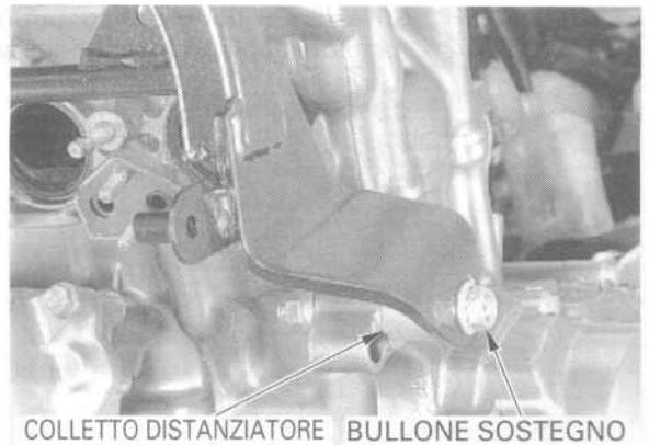
Installare la staffa del sostegno anteriore destro motore e stringere i bulloni applicando la coppia specificata.
