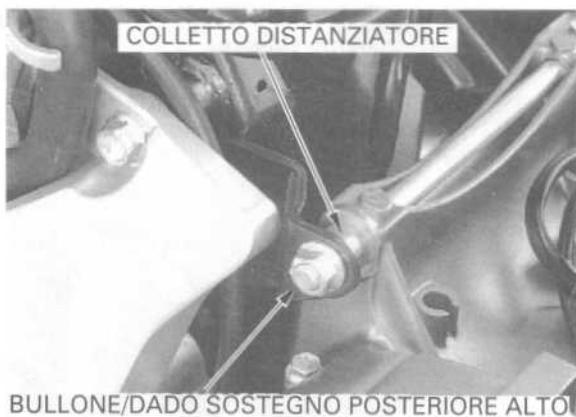
Installare il bullone/dado del sostegno posteriore basso motore e il colletto distanziatore
