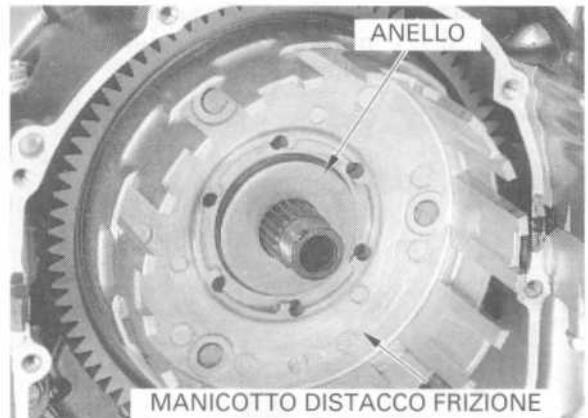
Applicare uno strato di olio motore ai dischi e alle piastre della frizione.
