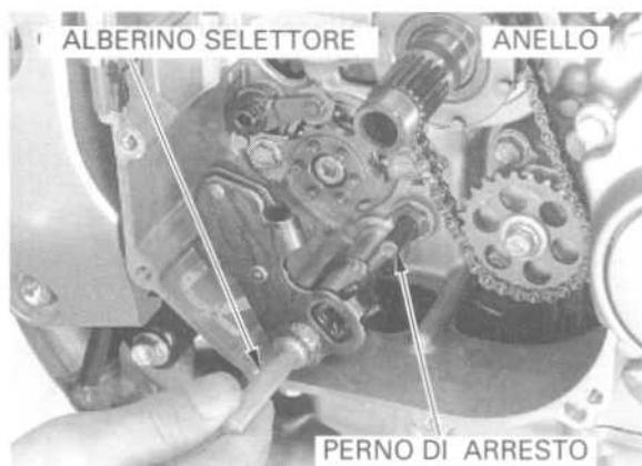
Installare il giunto del pedale cambio allineando la fenditura con il marchio a punzone sull'alberino del selettore marce.
