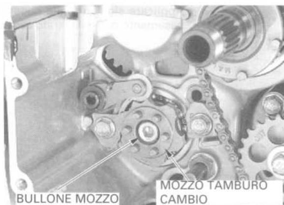
Installare l'anello di spinta e il gruppo dell'alberino del selettore nel basamento, allineando le estremità delle molle con lo spinotto di fermo del basamento.
