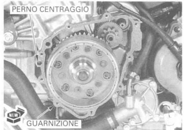
Installare la copertura dell'alternatore.
