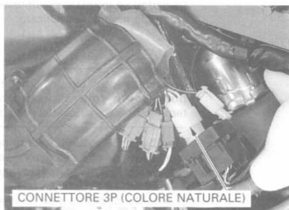
Controllare la resistenza tra tutti e tre i terminali gialli.
