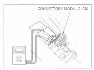
Controllare che la resistenza tra i terminali dei fili Rosso/Giallo e blu vari con il variare della posizione, della valvola a farfalla, azionando la manopola del gas.
