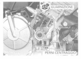
Applicare sigillante ai filetti dei due bulloni contassegnati con il marchio " $\Delta$ " sulla copertura. Installare la copertura del rotore del generatore di impulsi di accensione e stringere il bullone SH.
