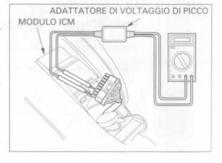
Se il voltaggio di picco misurato sul connettore multilpo del modulo ICM è anomalo, misurare il voltaggio di picco sul connettore del generatore di impulsi di accensione.
