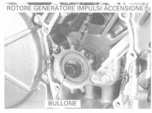
Installare il generatore di impulsi di accensione nella copertura.
