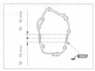
Installare i perni di centraggio e una nuova guarnizione.
