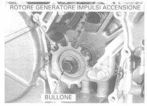
Installare il rotore del generatore di impulsi di accensione, allineando la scanalatura larga con il risalto sull'albero motore.
