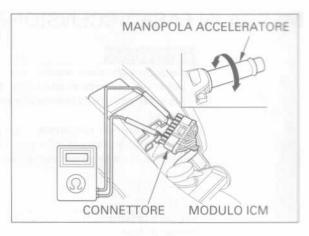
Se non è possibile ottenere le misurazioni corrette, staccare il connettore 3P (nero) del sensore acceleratore ed eseguire gli stessi controlli sui terminali del sensore.
