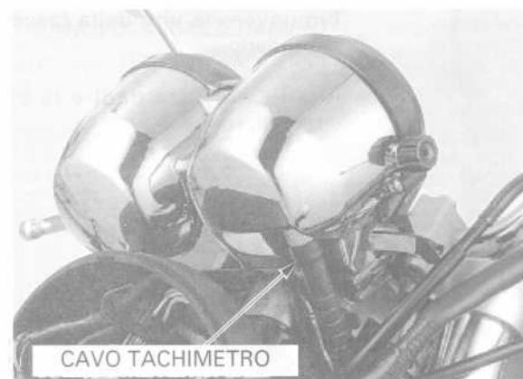
Rimuovere i due bulloni a esagono cavo e il blocco del gruppo strumentazione.
