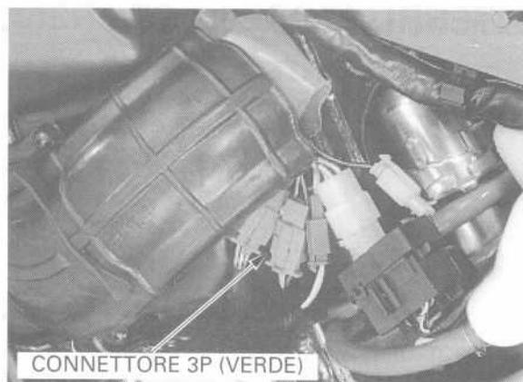
Controllare la continuità tra i terminali dei fili sul connettore dell'interruttore del cavalletto laterale. Deve esserci continuità con il cavalletto laterale alzato e non deve esserci continuità con il cavalletto laterale abbassato.
