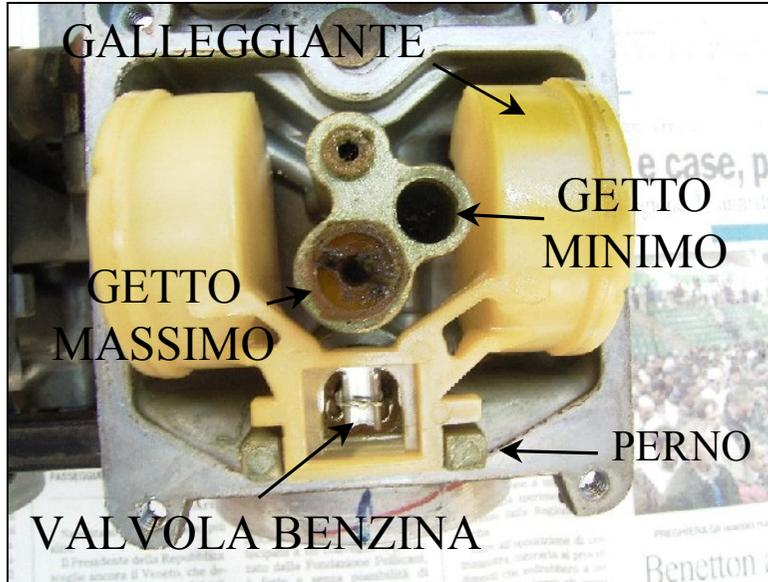
non la si debba sostituire perché screpolata, rotta o ci sono perdite di benzina. Visto il costo dei ricambi originali consiglio di trattarla con cura. Per togliere il galleggiante è sufficiente sfilare il perno che lo tiene vincolato al corpo carburatore. Insieme al galleggiante verrà via anche la valvola che regola l'afflusso di benzina alla vaschetta
