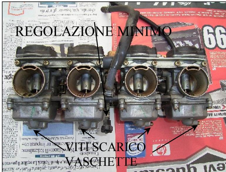
Togliere le quattro viti nere che fissano il coperchio superiore del carburatore. Sotto c'è la molla della valvola a saracinesca e se non si presta attenzione, ci si potrebbe trovare con i pezzi sparsi in giro. Una delle viti del carburatore N°4 fissa anche il
