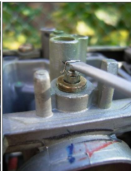
attenzione si rischia di vedere schizzare via tutto. Allo stesso modo si può procedere per gli altri carburatori avendo l'accortezza di dividere i pezzi di un carburatore dall'altro. Ora che è tutto smontato puliamo i vari pezzi con del diluente e una volta finito si può procedere al rimontaggio, al collaudo e alla taratura. Prima di cominciare il rimontaggio verificare la valvola di
