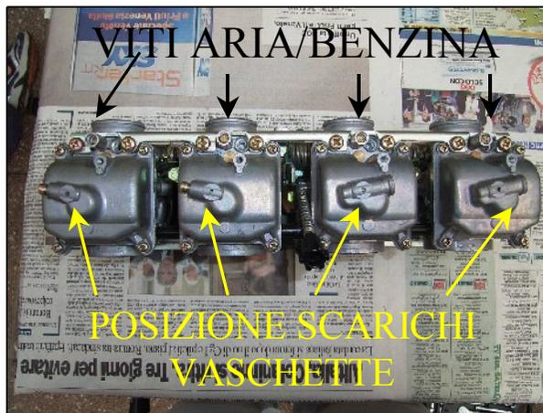
l'altezza del galleggiante. Il manuale di servizio indica che l'altezza tra il bordo del corpo carburatore e la parte inferiore del galleggiante quando questo è appena appoggiato
